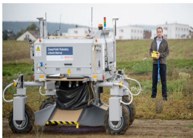
Figura 11 - BoniRob, capaz de analisar os solos e a sua composição assim como remover ervas daninhas.
